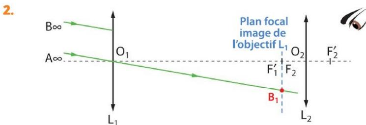
2 Puisque les faisceaux incidents sont parallèles entre eux, ils vont se croiser dans le plan focal image de l'objectif  $L_1$  : au niveau du foyer secondaire image  $B_1$ .
