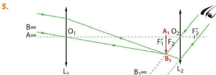
5 Dernière étape, on prolonge le rayon d'étude jusqu'à l'oculaire et on trace sa partie émergente. L'image intermédiaire se trouvant dans le plan focal objet de l'oculaire, tous les faisceaux émergents sont parallèles entre eux : l'image définitive  $A_2B_2$  est à l'infini (c'est bien le but de la lunette afocale !).
