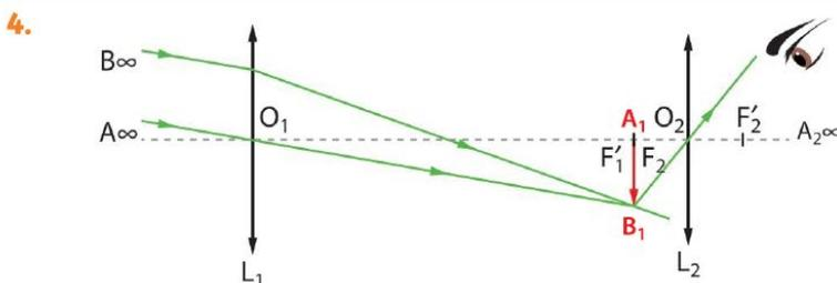
4 Il faut maintenant considérer l'image intermédiaire  $A_1B_1$  comme l'objet de l'oculaire. Pour cela, il faut chercher l'image de  $B_1$  à travers l'oculaire  $L_2$ . Pour cela, on choisit le rayon le plus simple, celui passant par le centre optique  $O_2$ .
