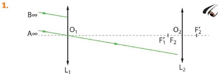
1 Il faut s'appuyer sur des faisceaux dont on est capable de connaître la déviation à travers la lentille. L'objet étant à l'infini, les faisceaux incidents sont tous parallèles entre eux. Le plus simple à tracer est le faisceau passant par le centre optique  $O_1$  puisqu'il n'est pas dévié.
