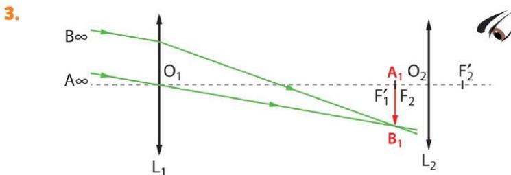
3 Tous les faisceaux émergents de l'objectif  $L_1$  se croisent en  $B_1$ . Le point  $A_1$  est placé sur l'axe optique de façon à obtenir l'image intermédiaire  $A_1B_1$  perpendiculaire à l'axe optique.
