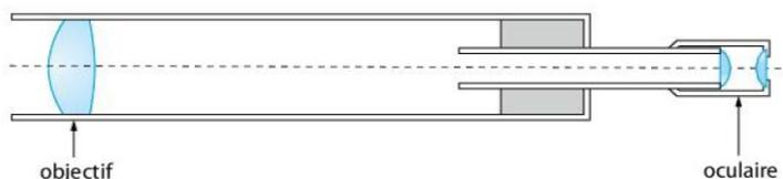
Une lunette astronomique qui donne d'un **objet à l'infini**, une **image à l'infini**, donc observable sans accommodation pour un œil normal, est dite **afocale**. Le foyer image  $F_1$  de l'objectif **coïncide** avec le foyer objet  $F_2$  de l'oculaire.
